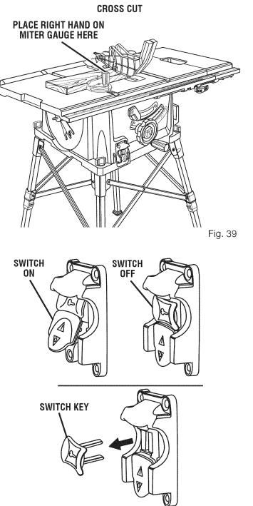
SWITCH IN LOCKED POSITION
